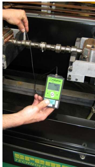
Mesureur numérique de champ magnétique tangentiel affichant simultanément les valeurs : moyenne, crête vraie et efficace vraie
